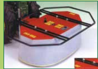
Kreiselmäher mit 2 Scheiben. Arbeitsbreite 80 cm
